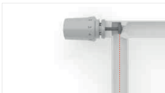
Radiaatoriventil sulgub, mahuline vooluhulk väheneb
